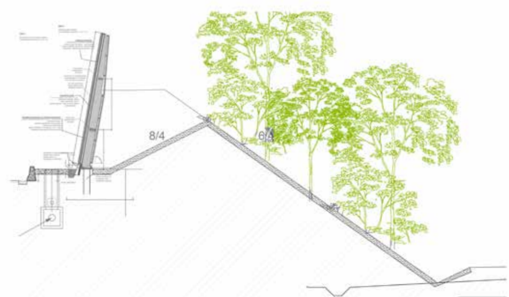
Opbouw van de houten absorberende geluidsschermen. © Ontwerpteam Ringpark West
