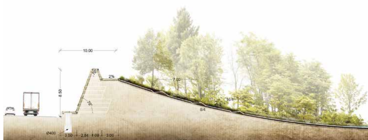
Een dwarsprofiel van de geluidsberm 70° toont het geluidstechnisch en landschappelijk uitgangspunt van het geluidsproject. © Ontwerpteam Ringpark West
