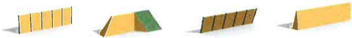
Combinatie van (geluids)bermen en schermen - referentiebeelden en studiemodellen. © Ontwerpteam Ringpark Groene Vesten
